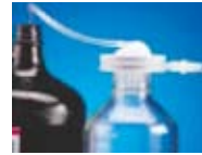
4. 進水管的另一端連接至要過濾的溶液樣品中
