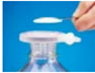
1. 將SolVac底部放至接收瓶上方，並加入過濾膜
