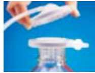
2. 進水管連接至上層SolVac，並靠著上下層吸鐵緊密結合
